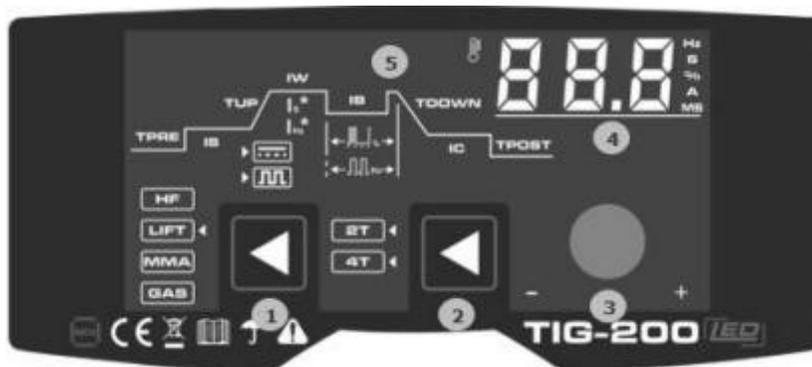
**1. Botón de selección de función Para seleccionar:** Modo -HF TIG /- Modo LIFI TIG /Modo MMA, Modo Gas Check /-Pulsación larga para seleccionar DC /PULSE
