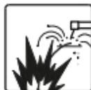
**a)** Remueva los riesgos de incendio del área de soldadura. Si esto no es posible, cúbralos para evitar que las chispas de soldadura provoquen un incendio. Recuerde que las chispas y materiales calientes de la soldadura pueden atravesar fácilmente pequeñas fisuras y aperturas, y penetrar en las áreas adyacentes. Evite soldar cerca de las líneas hidráulicas. Tenga un extinguidor de incendios a la mano.
