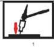
Pulse con el electrodo a la pieza de trabajo para activar el arco
