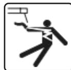
**a)** Los circuitos del electrodo y trabajo (o tierra) están eléctricamente “calientes” cuando la soldadora está encendida. No toque estas partes “calientes” con su piel desnuda o ropa mojada. Utilice guantes secos sin perforaciones para aislar sus manos.
