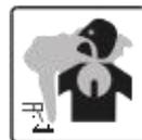
**a)** La soldadura puede producir humos y gases peligrosos para la salud. Evite respirar estos humos y gases. Cuando suelde, mantenga su cabeza fuera de los humos. Utilice suficiente ventilación y/o escape en el arco para mantener los humos y gases alejados de la zona de respiración.
