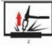
Levante el electrodo de la pieza de trabajo de alrededor de 2-5 mm
