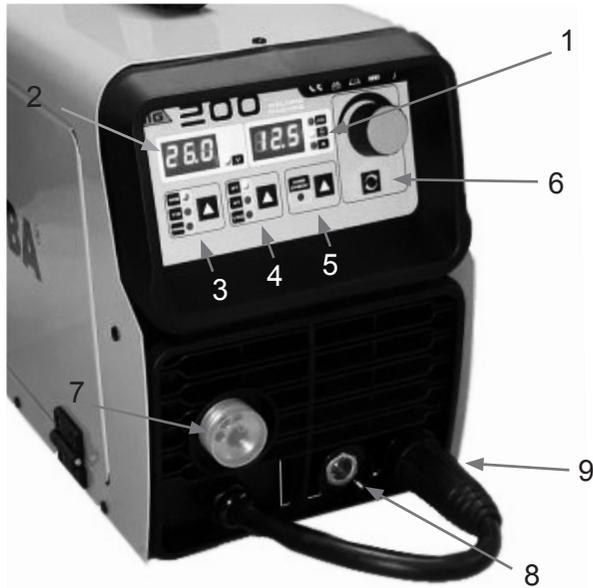
1. Exhibición actual: Exhibición de la corriente de soldadura cuando la máquina está trabajando, fije la corriente antes de la soldadura. Unidad: A.
